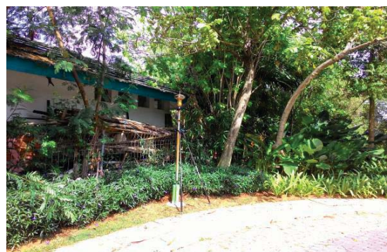
Gambar 5. Dokumentasi pengambilan data RTK GNSS GPS dan Beidou di obstruksi tertutup
