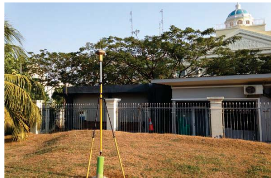
Gambar 4. Dokumentasi pengambilan data RTK GNSS GPS dan Beidou di obstruksi terbuka
